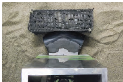
蛇籠構造体の適用性に関する模型実験の様子
