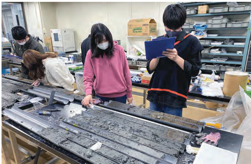
掘削したボーリングコアの観察と記載
